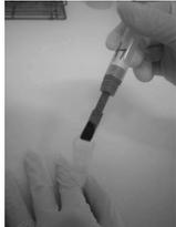
Enroskar bien el recolector filtro y la cámara de mezclado
