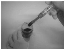
Introducir recolector-filtro en la cámara de mezclado ejerciendo presión, hasta sentir un tope
